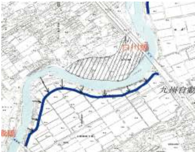
斜線部分が2012年7月洪水の浸水区域。 太い線まで川幅を広げる計画
