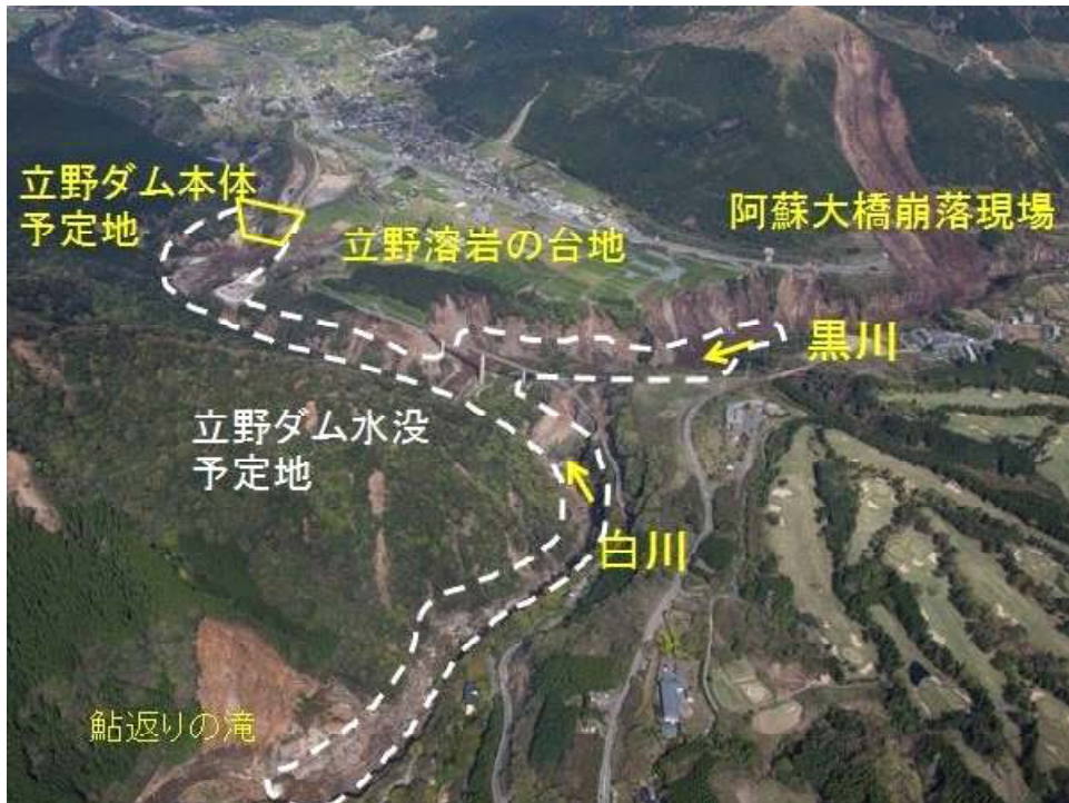
熊本地震後の立野ダム水没予定地。大半が土砂崩壊をしている。(パスコ航空写真に加筆) ダムの水位が上がれば、立野溶岩の表面に堆積した火山性堆積物が崩れ、 湛水(たんすい)地すべりが発生するのは明らかである。
